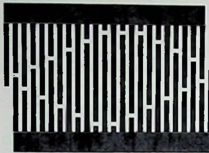
Bild 8. Wandler mit Fingern ungleicher Länge und zusätzlich „dummy“-Fingern. Neben den normalen, aktiven Fingern wurden auch inaktive angebracht, ohne die die abgestrahlte Wellenfront nicht völlig eben wäre.
